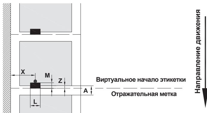
Рис. 24 Размеры отражающих меток
