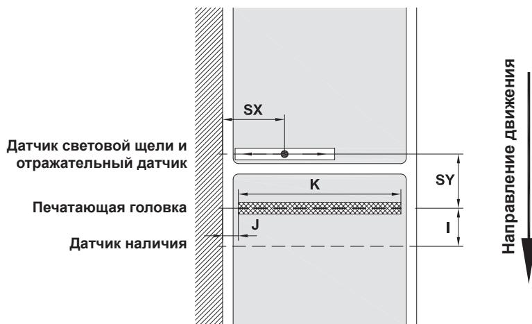
Рис. 23 Размеры устройства
