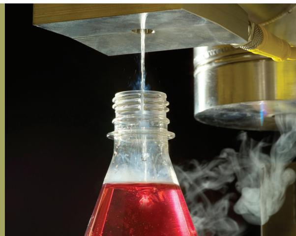
Системы инъекции жидкого азота NITRODOSE® компании Vacuum Barrier обеспечивают сверхточное дозирование жидкого азота в линиях розлива негазированных напитков для создания избыточного давления в легковесной упаковке и вытеснения кислорода азотом с целью увеличения срока хранения.
