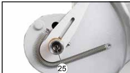
Винт **25** затянуть до упора, а затем медленно отпустить, пока рычаг **20** не отклонится примерно на  $45^\circ$  (см. следующий рисунок). Затем не изменять момент затяжки винта **25**.
