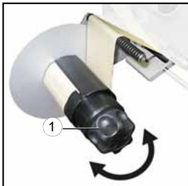
> Ручку **1** повернуть полностью влево (макс. 5 положений), чтобы открыть зажим и обеспечить доступ к крепежному винту **10**.
