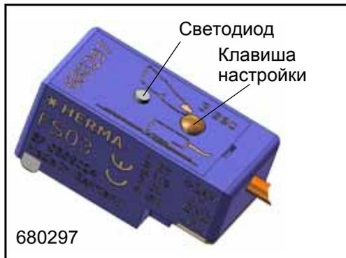
Сканер этикеток FS03 является самообучающимся узлом, подходящим как для бумажных этикеток, так и для электропроводящих этикеток (металлизированных или кашированных алюминиевой фольгой). Устройство настроено таким образом, что сканирование на этикетке активно по сигналу high (сигнал «1» на этикетке). Светодиод устройства показывает текущее состояние коммутационного выхода, т. е. он светится на этикетке и гаснет в промежутке между этикетками.
