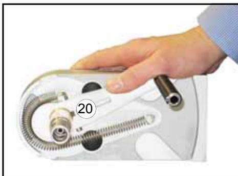
> Далеко отклонить рычаг **20**. Затяжной винт **18** слегка затянуть (не полностью), чтобы после отпускания рычаг оставался отклоненным, но его еще можно было поворачивать вручную. При этом следить за тем, чтобы фиксатор **17** был закреплен на валу без зазора.
