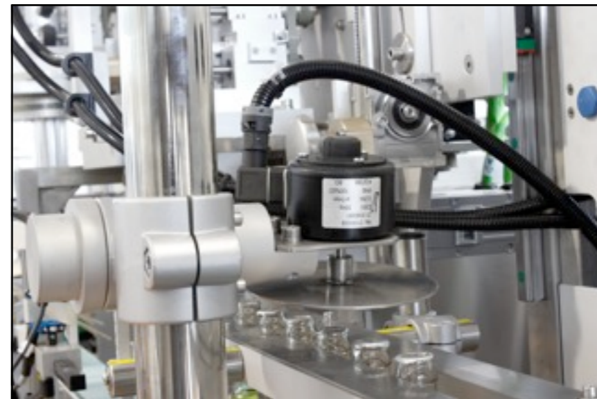
Вибрационный позиционер для размещения слив-этикетки на горлышко емкости
