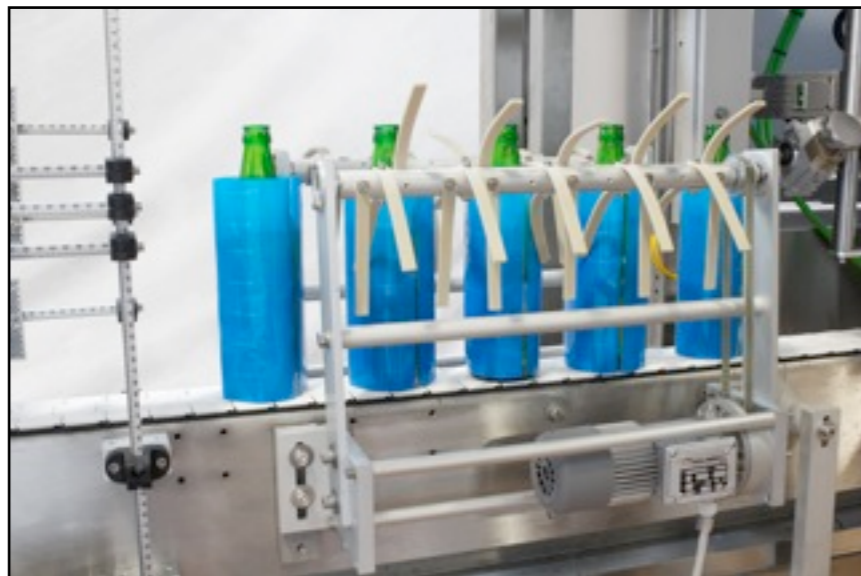
«щеточный» позиционер для слив-этикетки на полное тело
