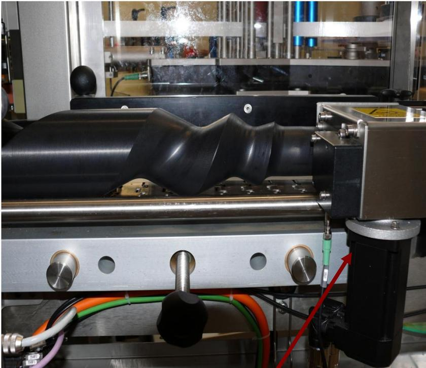
**Входной шнек, управляемый серво двигателем с функцией стоппера бутылок и контролем крутящего момента**
