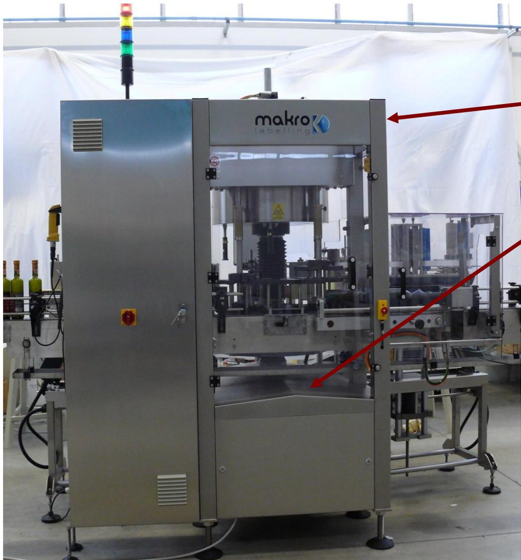
Рама из нержавеющей стали (AISI 304), установленная на регулируемые подставки;
